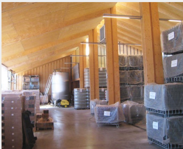
Le gabarit des portiques définit la largeur d'un bâtiment type. Ici accolé doublant la largeur dans l'espace stockage et conditionnement.
